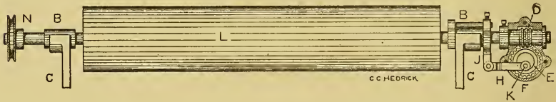
Fig. 88. Long Roll Grinder.
